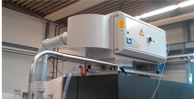
2 Elektrostatisches Filtrationssystem, installiert auf einer Werkzeugmaschine
